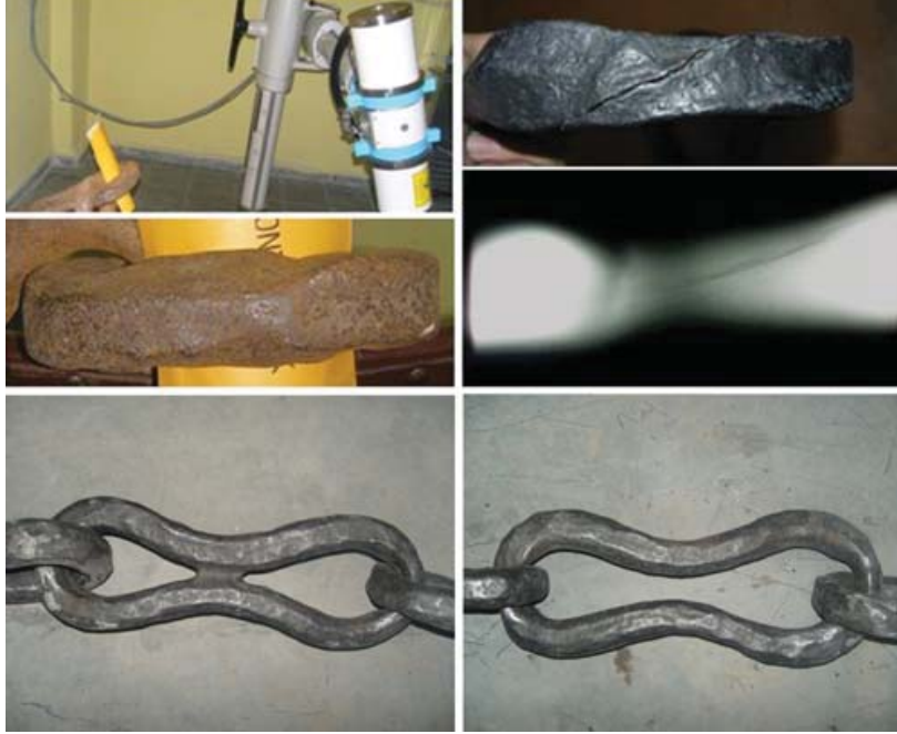
Resim 8) Zincir üzerinde yapılan radyografik incelemeler ve yapım tekniğini gösteren radyograf.
