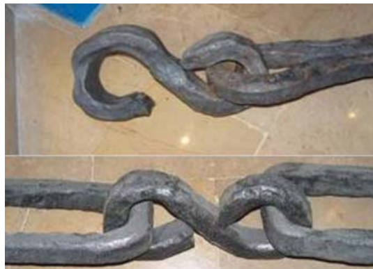
Resim 9) Boğumlu zincirde karşılaşılan “S” bakla yuvarlak zincirlerde görülmektedir.
