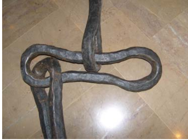
Resim 7) Ortası açık baklarda oluşan takılma sorunu.
